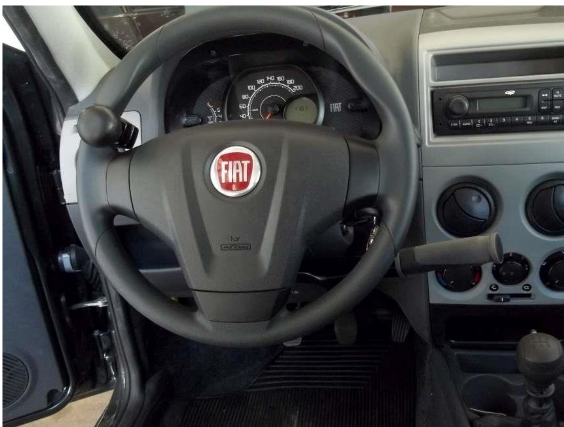
Figura 2 – Controlos exclusivamente manuais. Tal como com os extensores, esta imagem serve apenas de exemplo. O seu aspeto pode variar muito e há, inclusive, controlos manuais que se parecem com um anel por cima ou por baixo do volante e vários tipos de alavancas como a que se vê na imagem. Imagem de: Zezin Adaptações .
