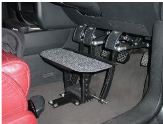
Figura 1 – Exemplo de extensores de pedais, pode encontrar extensores com outro aspeto. Imagem de: rica.org.uk
